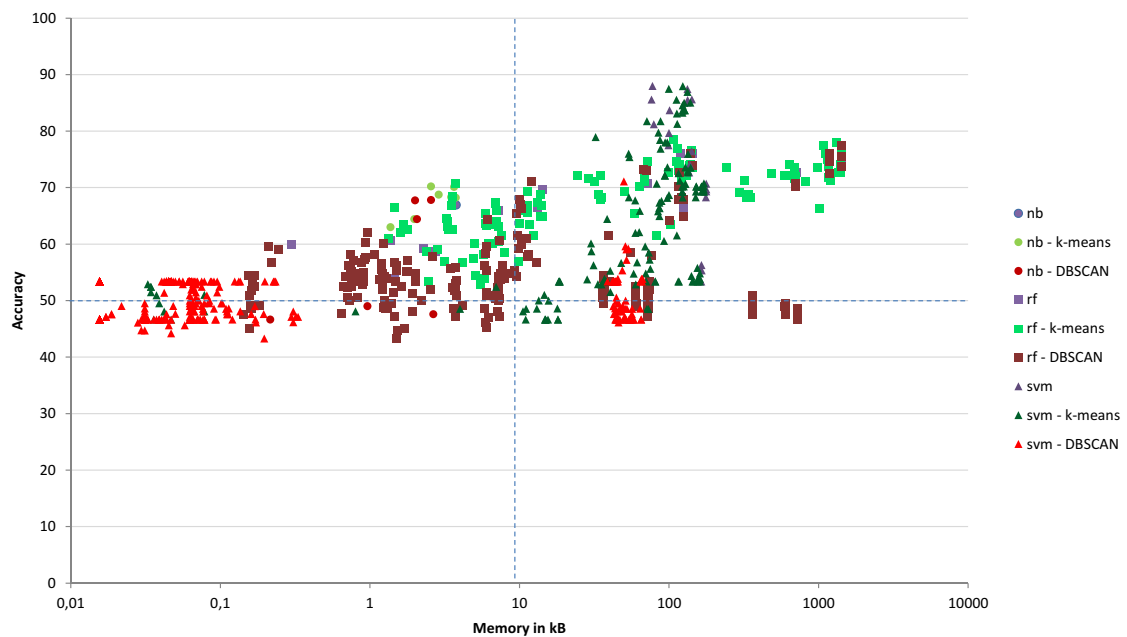
Abbildung 44: Diagramm zum Datensatz Sonar. Dieses auf den ersten Blick unübersichtliche Diagramm zeigt die Ergebnisse der Verfahren für die Klassifikation. Die Punkte stellen das Verfahren Naive Bayes dar, die Quadrate Random Forest und die Dreiecke sind die Ergebnisse der SVM. Die Verfahren sind ohne und mit Verbindung der zwei Clusterverfahren k -means und DBSCAN dargestellt.
