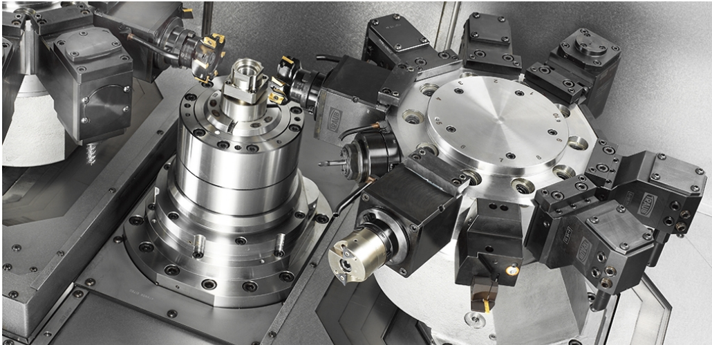
Abbildung 1.2: Mehrachsiges Bearbeitungszentrum mit einer Vielzahl von Werkzeugen 2 .
